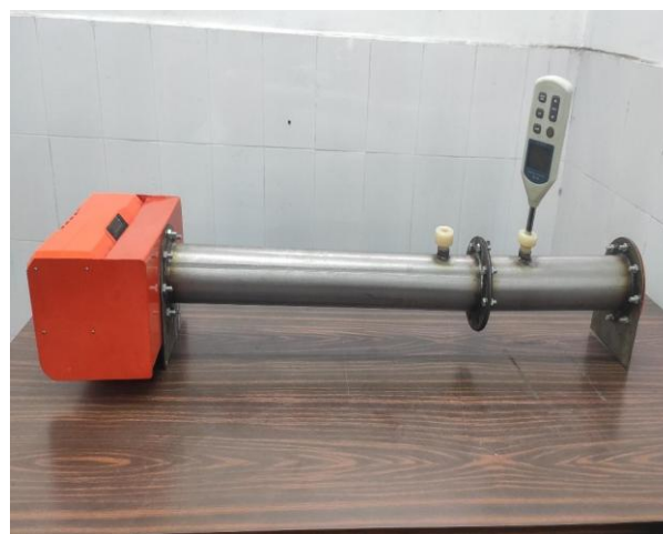
Figura 3. Prototipo tubo de medición acústica.
