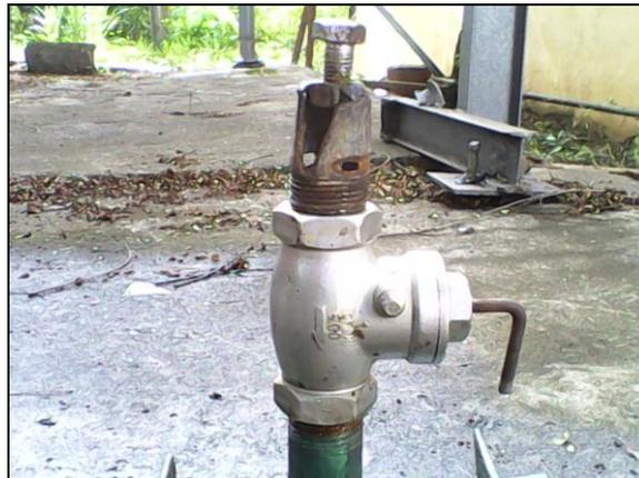
**Figura 1.** Válvula de paso modificada para impulso.
