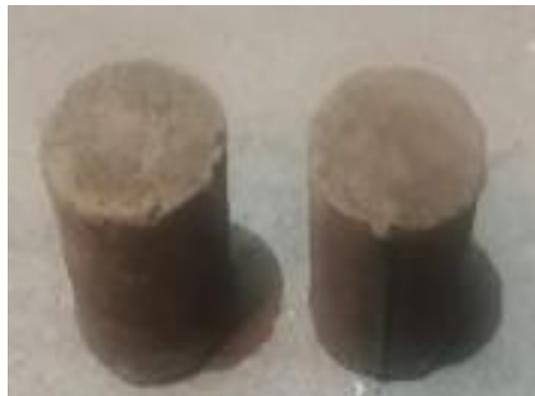
**Figura 2.** Probetas para ensayo de compresión.
