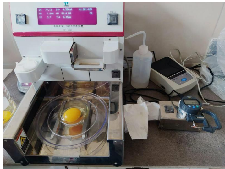
Figura 3. Análisis de altura de albúmina, coloración de yema, Unidades Haugh y grosor de la cáscara con el equipo Digital Egg Tester DET 6000.
