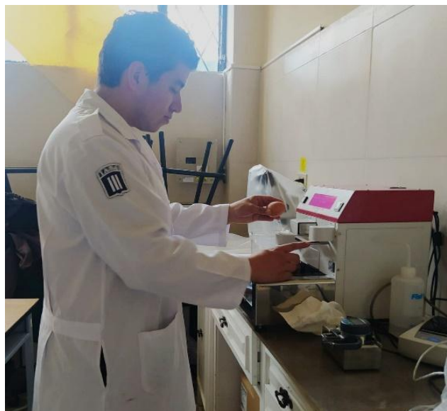
Figura 2. Análisis de peso y resistencia de la cáscara con el equipo Digital Egg Tester DET 6000.
