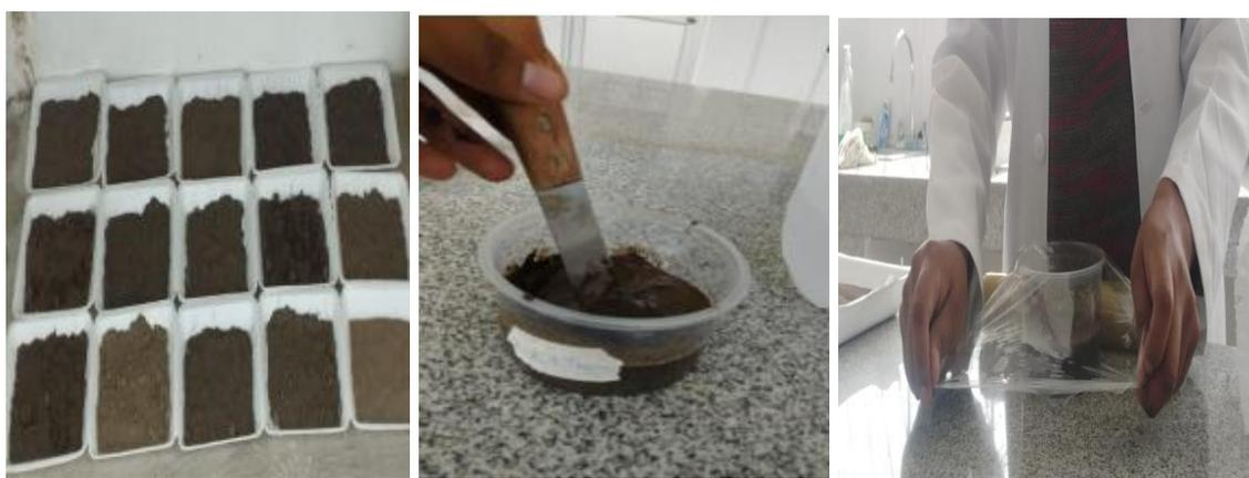
**Figura 8.** Procedimiento de la pasta del suelo de los diferentes lugares.
