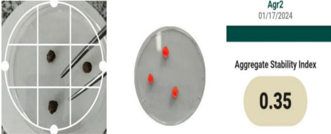
**Figura 10.** *Proceso de análisis mediante la tecnología móvil Slakes.*
