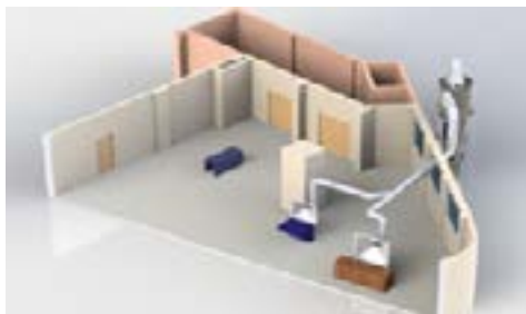
Figura 4. Vista frontal del sistema de extracción diseñado para el taller de la carpintería
