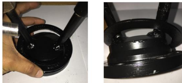
Figura 5. Anillo de la tapa del reactor.
