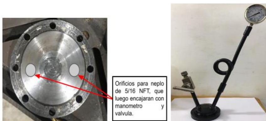
Figura 3. Tapa del reactor de alta presión.
