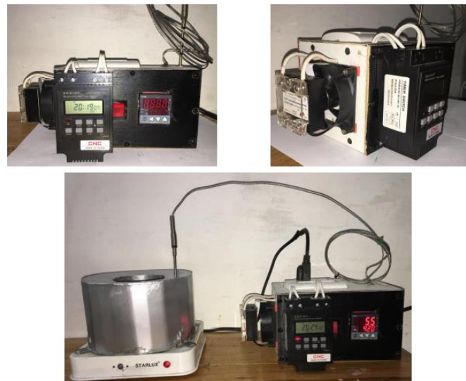
Figura 12. Controlador de tiempo, de temperatura y sensor de calor. Junto al calentador eléctrico.
