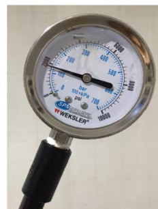
Figura 15. Reactor cargado, se observa la presión de 110 bar en el manómetro.
