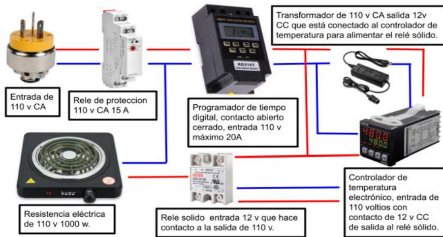
Figura 10. Instalación eléctrica de controlador de tiempo y temperatura.
