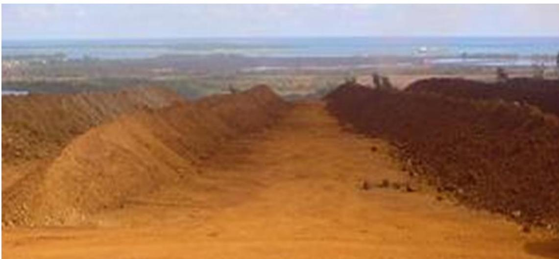
Figura 4. Implementación práctica del proceso de secado solar natural de las lateritas niquelíferas en pilas a granel [8].
