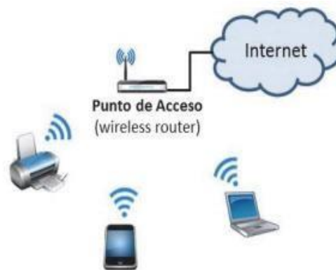
Figura 1. Esquema de redes WLAN en un hogar. [7]
