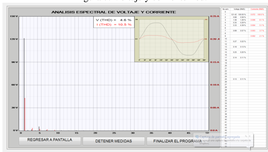
Figura 7. Voltaje y corriente Led.
