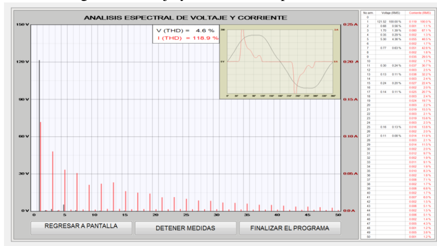
Figura 9: Voltaje y corriente Lámpara de Inducción
