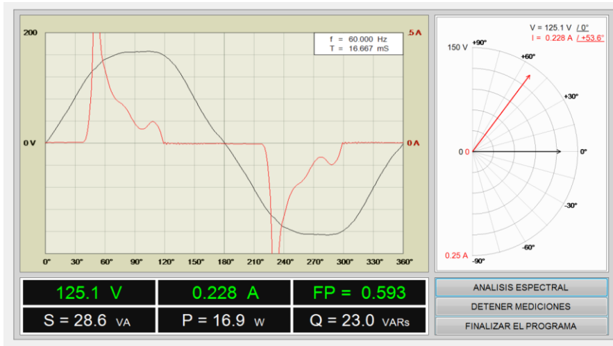
Figura 9: Voltaje y corriente Lámpara de Inducción
